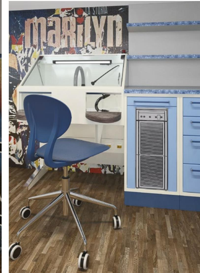
Un ejemplo de conexión con sistema de aspiración dotado de arranque automático para el box y para los singulos puestos de trabajo.
