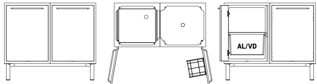
**Mueble H976 para lavabo doble y tipología apertura / Móvel H976 lavatório duplo e tipos de aberturas****AL/MLA2**
