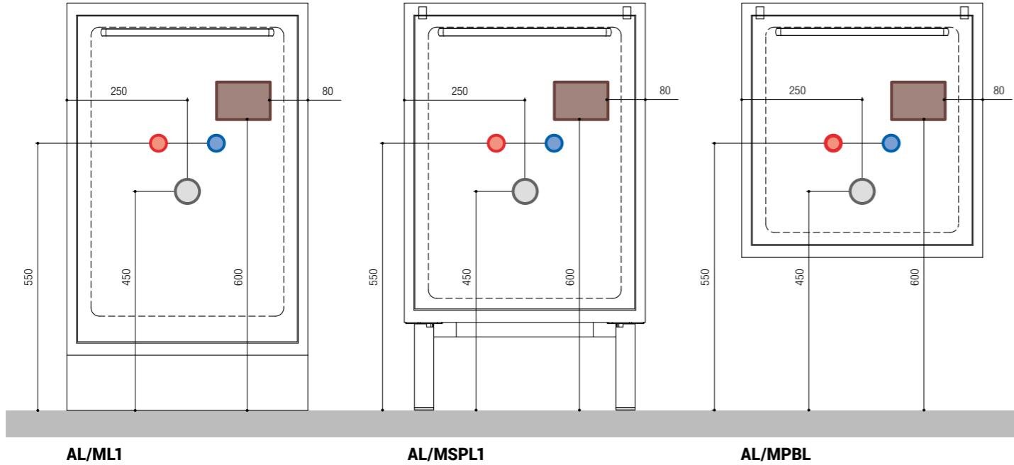
**Esquema colocación de las instalaciones en el mueble para lavabo doble.**
