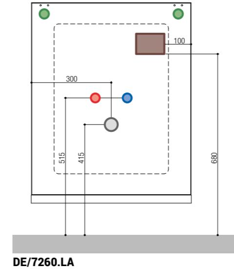
**Esquema colocación de las instalaciones en el mueble Pc.**
