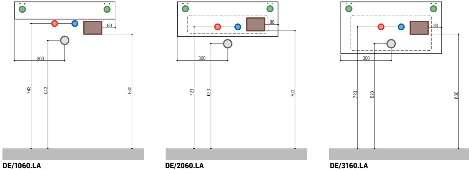
**Esquema colocación de las instalaciones en el mueble para lavabo.**
